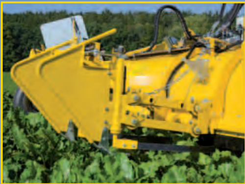
Hmatač řádků pro automatické řízení - s bezúdržbovým zavěšením
