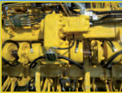
Pohon vibrační radliček převodovkou a seřizovatelnými kuželíkovými ložisky
