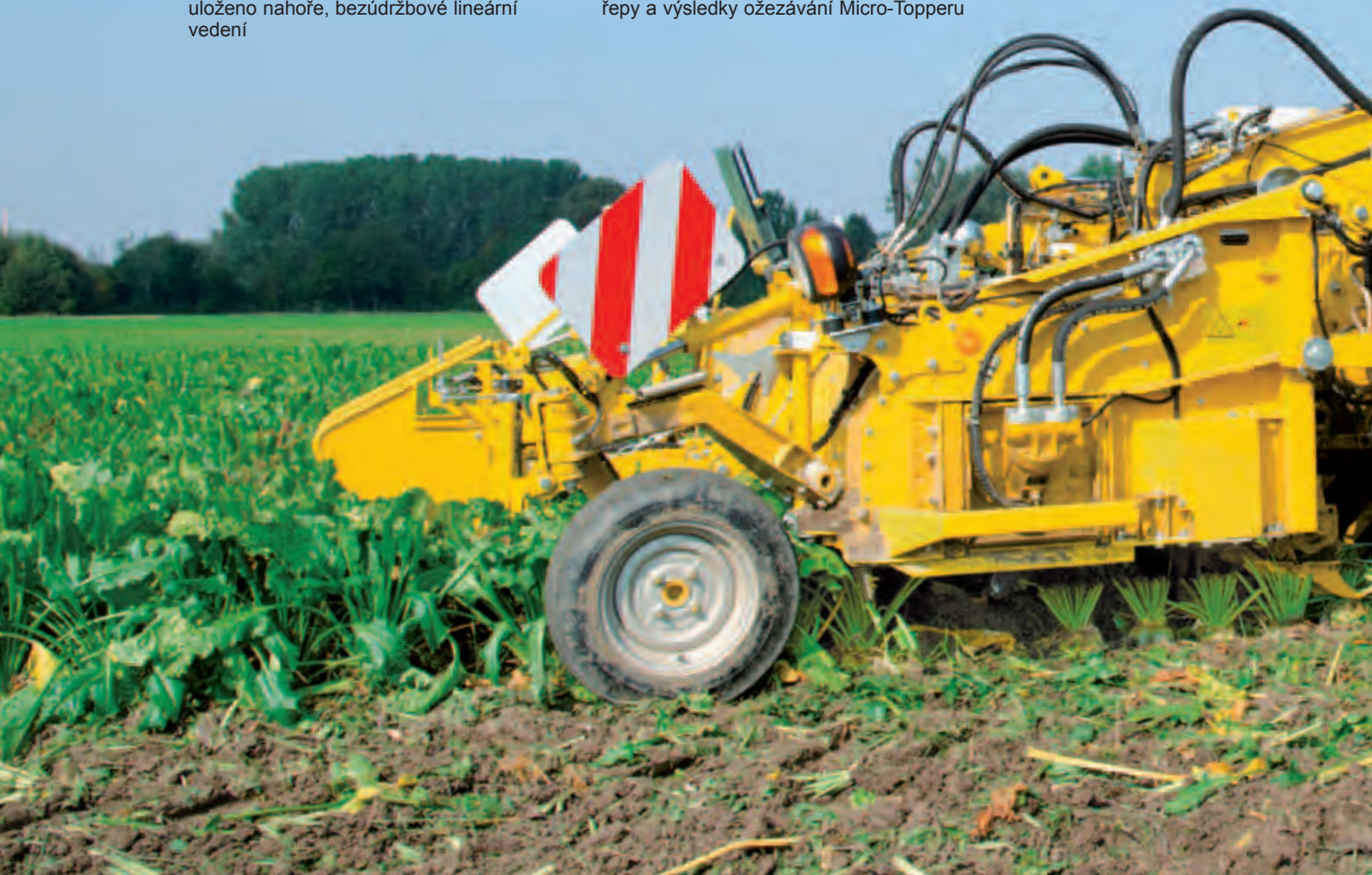
Velmi dobrý výhled do vyorávacího agregátu -> řidič vidí řádky řepy a výsledky ožezávání Micro-Topperu
