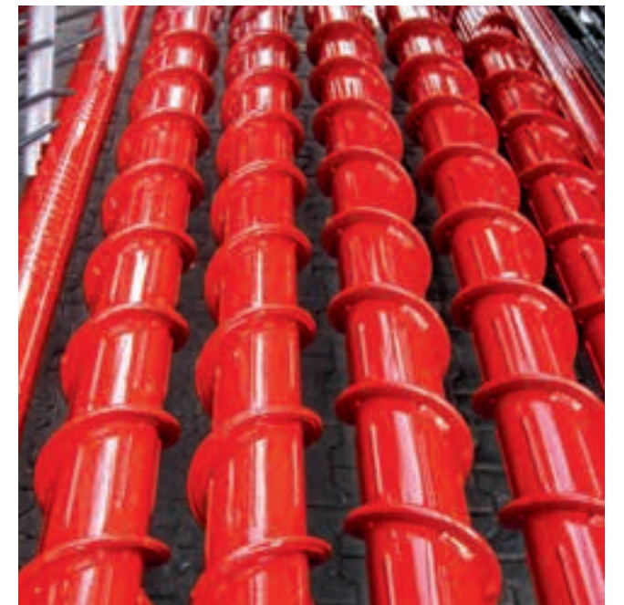
Doppelt bzw. vierfach vergütete Rodewalzen mit erhöhten Windungen.
